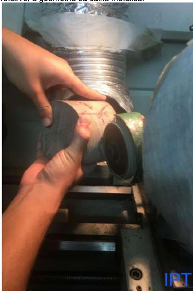
Foto 8: Adequação do corpo de prova, no torno rotativo, à geometria da caixa metálica.
