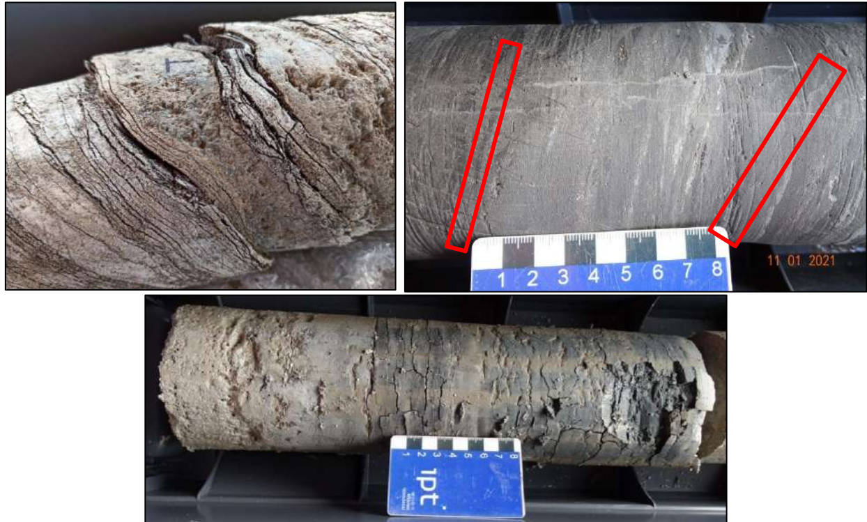
Figura 5: À esquerda, amostra com presença de trincas devido à perda de umidade no trecho. À direita, fissuras (destacadas em vermelho) presentes na amostra de folhelho. Na foto inferior, trecho de margas, que sofreram trincas de retração.
