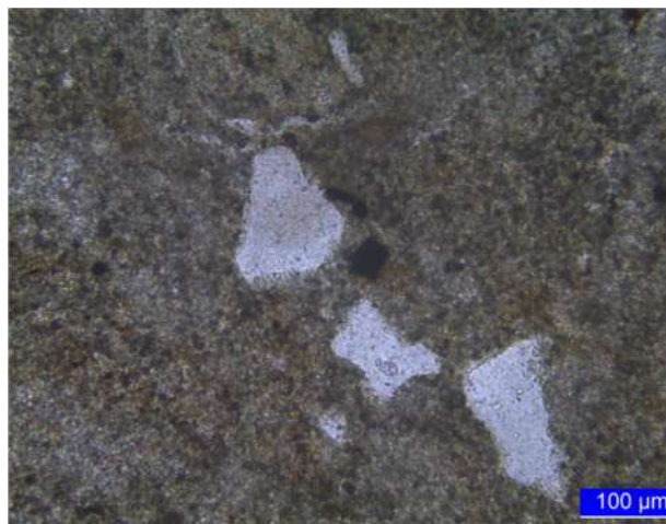
Fotomicrografia 4 - “Caixa 123 – 179,34 a 179,54 m - MOS” (LMCC N° 3164-21). Ao centro da imagem, grão de mineral opaco (possível pirita), parcialmente alterada em hidróxidos de ferro. Polarização cruzada.
