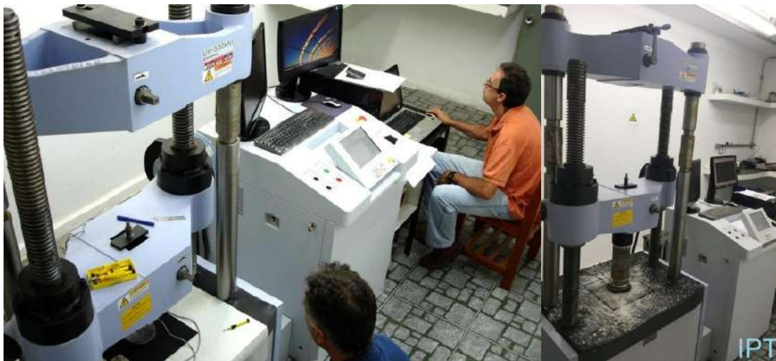
Foto 1: Vista da Máquina Universal de Ensaio modelo UH-500kNI da Shimadzu.
