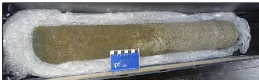
Figura 11: Caixa contendo um trecho do testemunho com proteções provisórias em plástico-bolha, para proteção apenas em canteiro, sem transporte por veículos.
