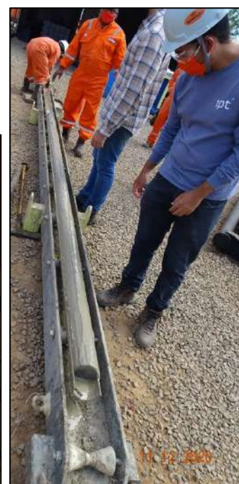
Figura 13: Limpeza e análise inicial do testemunho para programação de corte da rocha.
