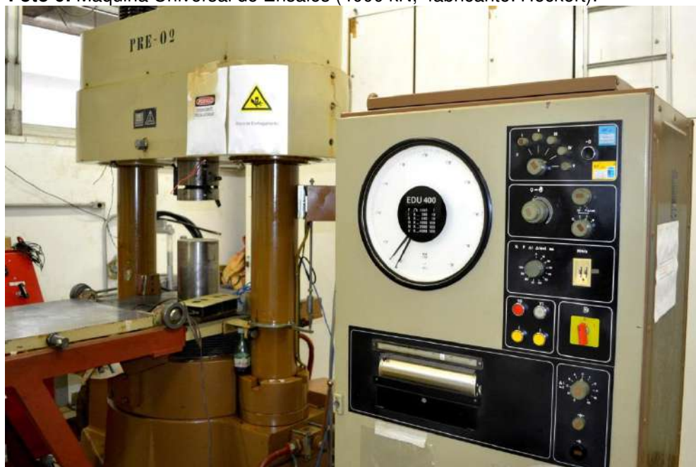
Foto 6: Máquina Universal de Ensaios (4000 kN, fabricante: Heckert).
