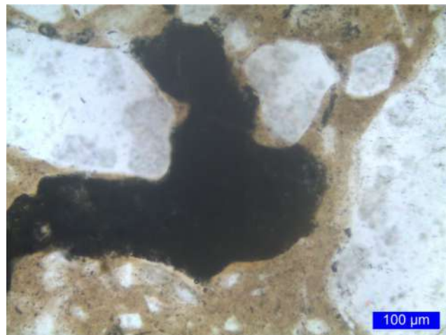
Fotomicrografia 10 - “Caixa 226 – 275,62 a 275,76 m - MRT” (LMCC N° 3165-21). Ao centro da imagem, material opaco (possível matéria orgânica). Polarização simples, com condensador.
