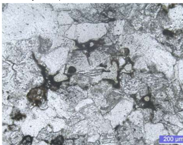
Fotomicrografia 18 - “Caixa 349 – 388,14 a 388,30 m - PAR” (LMCC N° 3166-21). Vazios de dissolução formados por alteração de provável pirita. Polarização simples.
