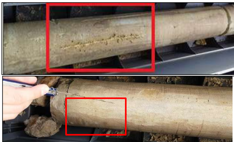
Figura 4: Trecho de dois testemunhos considerados como muito brando a brando. Nota-se que foi possível riscar/descascar o trecho com o canivete, porém, os sulcos não foram profundos
