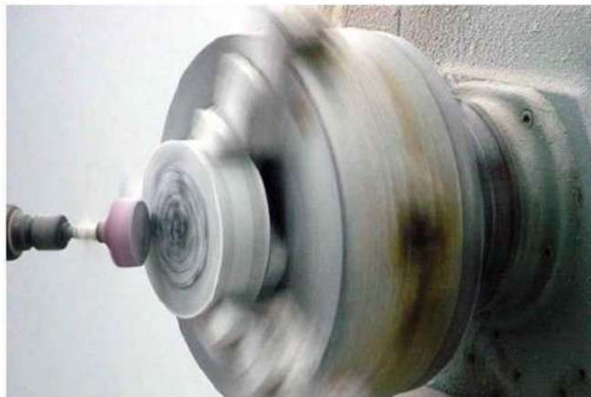
Foto 12: Detalhe do corpo de prova sendo preparado em torno rotativo.
