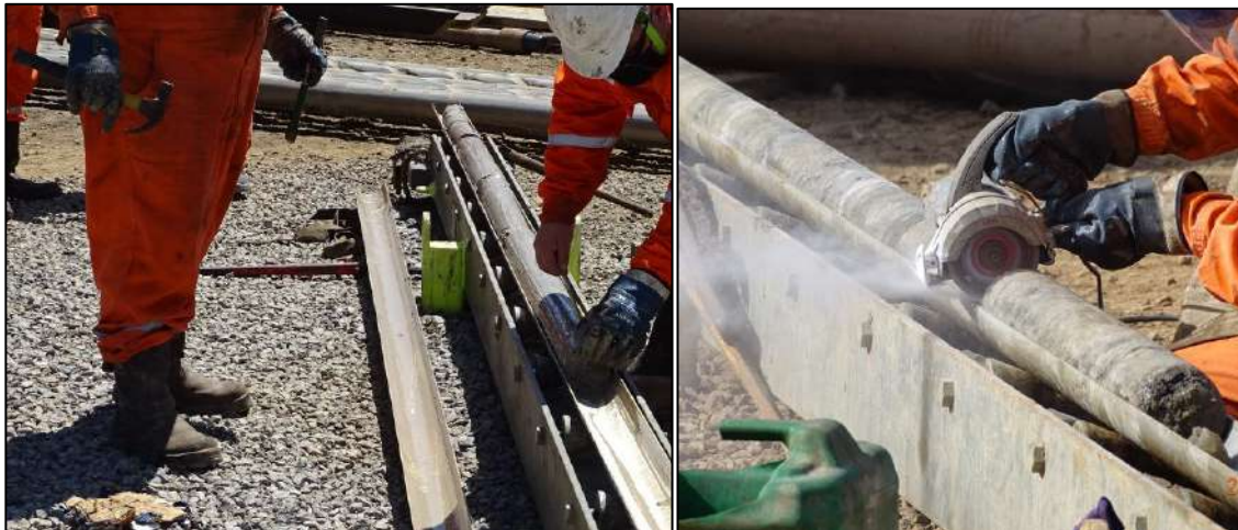
Figura 14: À esquerda, divisão do teste no berço com o uso de talhadeira e martelo (nas mãos do operador a esquerda da foto). À direita, corte do sal com uso de serra elétrica circular.
