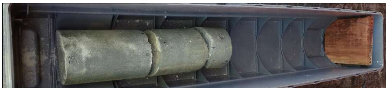
Figura 12: Final do testemunho 196, com a plaqueta de madeira identificando o avanço (A= 2,0 m), recuperação (R= 2,0 m) e profundidade final do testemunho (693,49).
