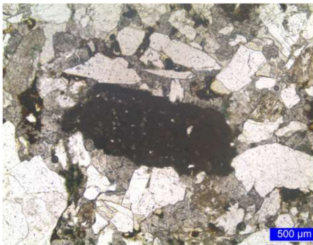
Fotomicrografia 15 - “Caixa 349 – 388,14 a 388,30 m - PAR” (LMCC N° 3166-21). Ao centro da imagem, pelota de lama com presença de silte. Polarização simples.
