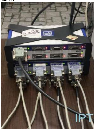
Foto 4: Sistema de aquisição de sinais MX840A do fabricante HBM.
